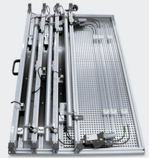
▲ Abb.: Simulationen an einem Schiebedach (Referenzierungs-Anschläge, Blockierung auf Normal-Verfahrweg)
