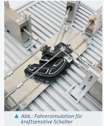
▲ Abb.: Fahrersimulation für kraftsensitive Schalter
